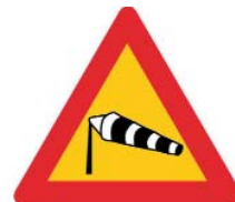
(K-23) Κίνδυνος λόγω συχνού ισχυρού ανέμου (όπως δείχνει η κατεύθυνση του ανεμουρίου).
