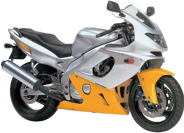
Σχ. 3.5β Ολόσωμη κατασκευη προστασίας.
