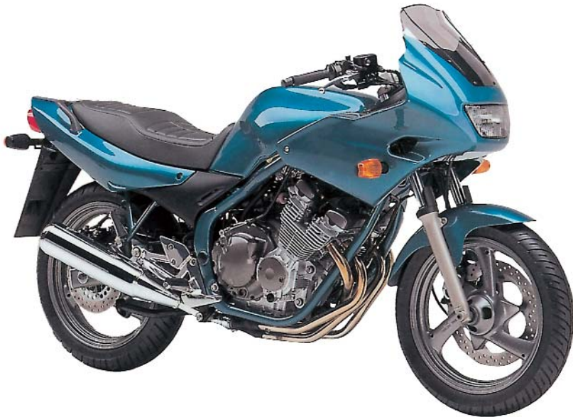
Σχ. 3.5γ Αεροδυναμική κατασκευη προστασίας τουριστικής μοτοσυκλέτας.
